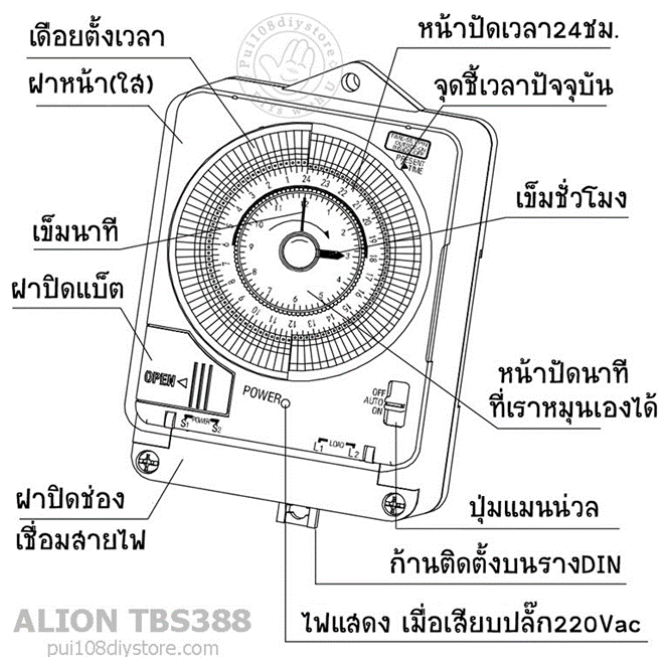
รูปที่ 5 แบบตัวอย่างระบบเปิด-ปิดไฟอัตโนมัติ
